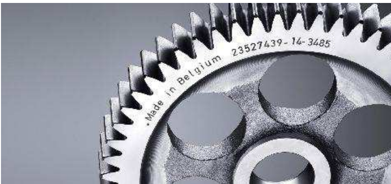
Abb. 12: Zahnrad mit Lasergravur (Trumpf, 2022)
