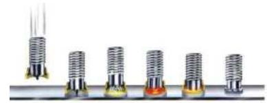
Abb. 27: Schweißbolzen Schweißprozess (Construction, 2022)
