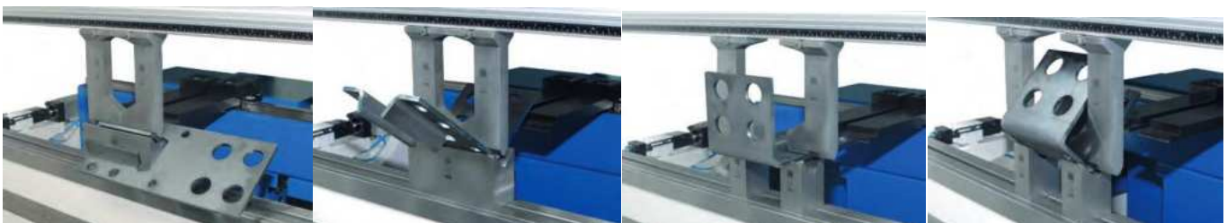
Abb. 21: Trumpf Hornwerkzeug, Teil schwenkt in die Hornausnehmung (Trumpf, 2022)
