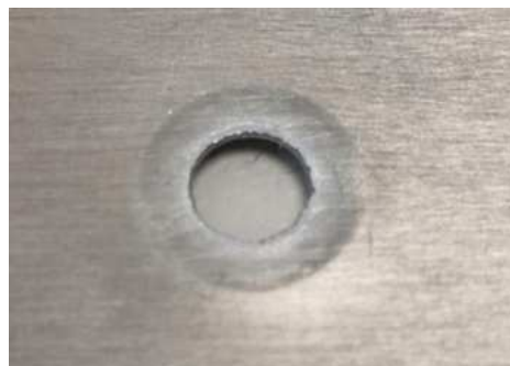
Abb. 5.2: Senkung im Alu von unten (Futronika, 2022)
