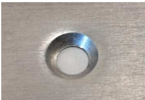
Abb. 5.1: Senkung im Alu von oben (Futronika, 2022)
