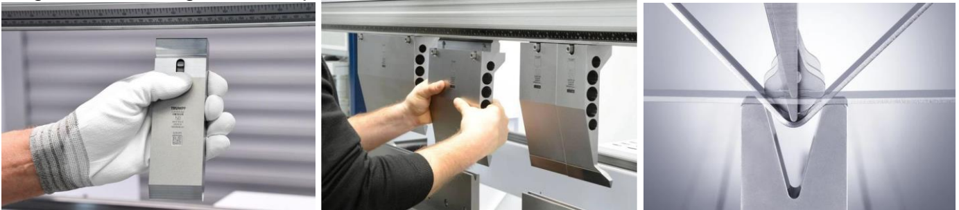
Abb. 15: Standardwerkzeug, Leichtbauwerkzeug und Sensorwerkzeug (Trumpf, 2022) ( https://www.trumpf.com/de_DE/produkte/maschinen-systeme/biegemaschinen/trubend-serie-5000/ )
